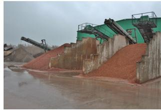
Der 0-8 Ziegel RC Sand und der 8-32 Ziegel RC werden von Nestler in Verbindung mit Wasser, Sand und Zement zu den zertifizierten Blöcken weiterverarbeitet.
