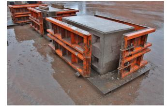
Durch die Betonblock-Formen wird aus Abraum neues Baumaterial.
